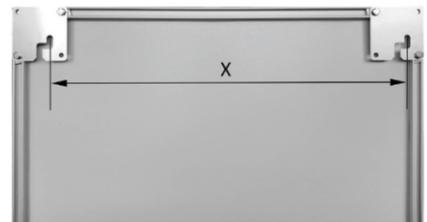
Messen Sie den mittleren Abstand (X) zwischen den Befestigungsschlitzten und übertragen Sie diesen auf die Wand, an der das Element befestigt werden soll. Verwenden Sie zum Ausrichten eine Wasserwaage. Bohren Sie an den markierten Punkten mit geeignetem Bohrer Löcher mit 8 mm Durchmesser und einer Mindesttiefe von 60 mm. Stecken Sie die Dübel (F) in die Löcher, achten Sie dabei darauf, dass diese bis zum Bund eingesetzt sind. Die Dübel sind universell verwendbar, auch für Hohlwände.
