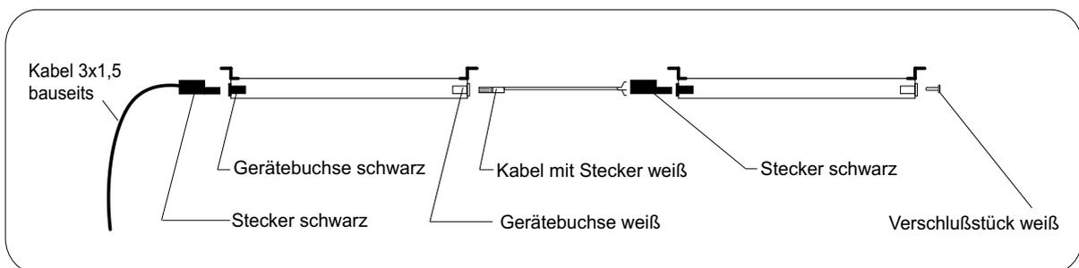
Das infera Niedertemperatur-Strahlungs-Element-Flach muß zur Montage nicht zerlegt werden. Das Heizgerät wird unter der Sitzfläche (Bankmitte) festgeschraubt.
