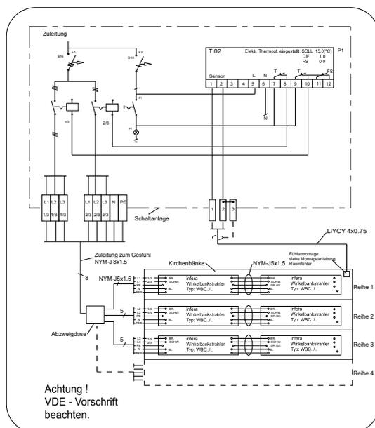
Durch Drehen des Heizgeräts kann der Winkelbankstrahler unter der Sitzfläche (Bankmitte) festgeschraubt. Die Zuleitung ist an der Bankunterseite zu befestigen und stirnseitig in das Gerät einzuführen.
