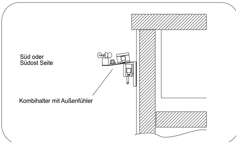
Der infera Kombihalter mit den Außenfühlern für infera Lüftungsregler wird in der Regel auf der Süd oder Südost Seite des Gebäudes montiert.
