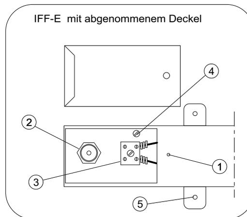
Das Anschlusskabel wird von hinten in die Membrantülle eingeführt. Die Zuleitung darf nicht unter dem Heizgerät geführt werden.
