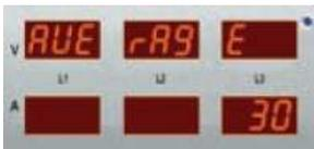
Mit der nächsten selbstständig erscheinenden Seite kann die gewünschte Hauptanzeige eingestellt werden. Diese Anzeige erscheint beim Einschalten des Gerätes (oder nach einem Stromausfall). Durch wiederholtes Drücken der Taste erscheinen die verschiedenen verfügbaren Messeiten. Wenn die gewünschte Seite erscheint lassen Sie die Taste los. Die Hauptanzeige ist damit gespeichert
