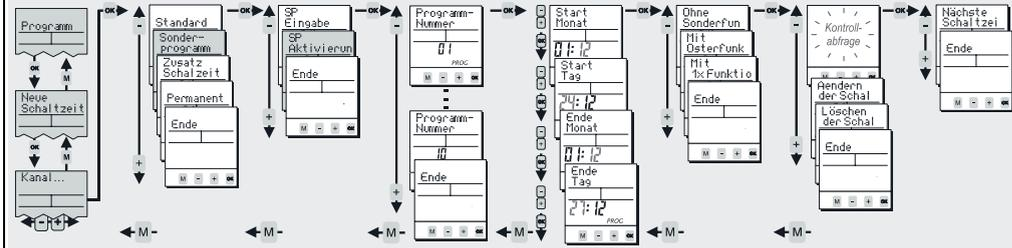
Erst nach Aktivierung der Sonderprogramme werden diese ausgeführt (Bitte beachten Sie die Priorität der Sonderprogramme (Punkt 15)). Sonderprogramme können, innerhalb der Speicherkapazität, beliebig oft aktiviert werden. Nach dem Sie festgelegt haben welches Sonderprogramm (**Programm-Nummer**) für welche Programmlaufzeit (**Startdatum bis Enddatum**) aktiviert werden soll, stehen Ihnen folgende weitere Optionen zur Verfügung:
